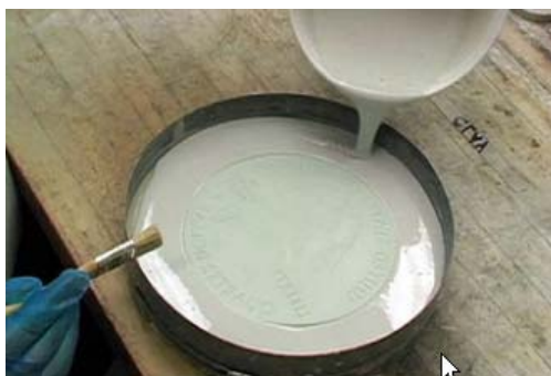
Ilustración 48 - Creando el plástico por vaciado vertiendo resina de epoxi.
