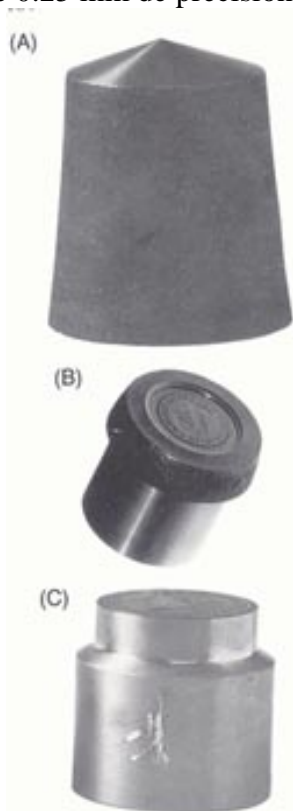
Ilustración 38 – (A) Punta de acero, (B) troquel hincado, (C) troquel mecanizado .
