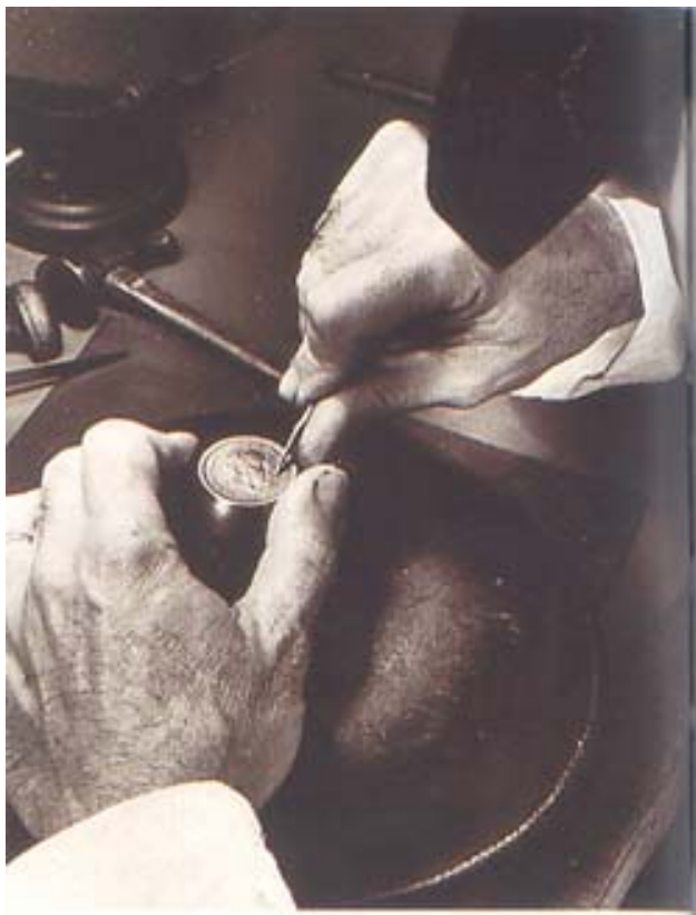
Ilustración 53 – Un grabador afina los perfiles de un punzón
