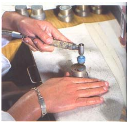
Ilustración 54 – Pulido de Troqueles con pasta de diamante
