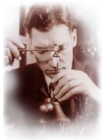
Ilustración 37 – Grabador usando maceta y buril
