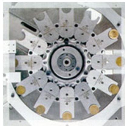
Ilustración 75: Disco giratorio de alimentación con alveolos para los coseles
