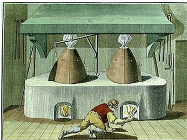
Ilustración 28 – Horno con dos crisoles para fundir metal
