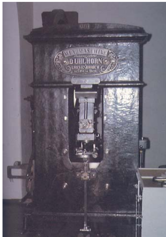
Ilustración 34 - Prensa Uhlhorn accionada por el vapor
