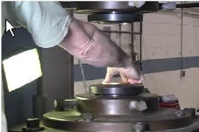
Ilustración 69 - La medalla es colocada manualmente entre los troqueles en una prensa especial que acuña a gran presión.
