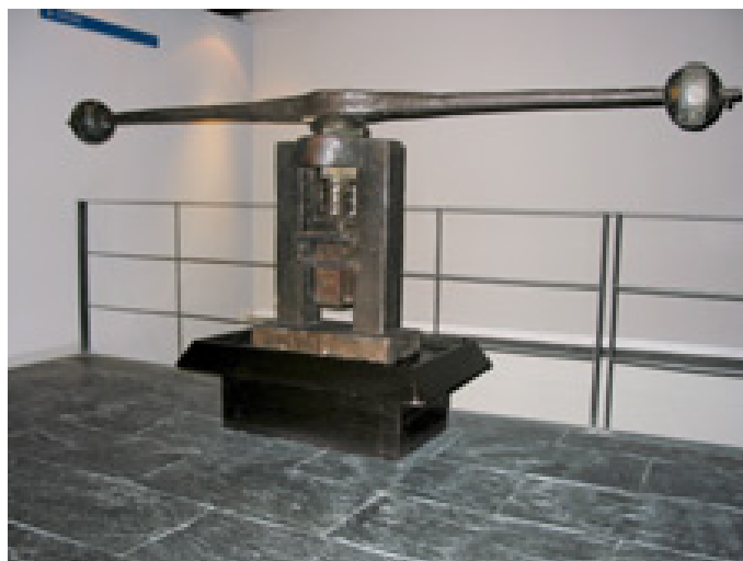
Ilustración 20 – Prensa Volante del Siglo XVII usada en Pamplona (Museo de Navarra).
