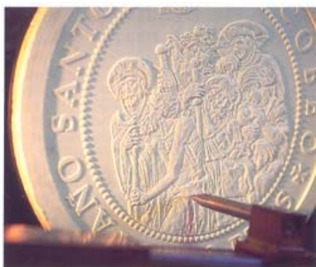
Ilustración 49 – Plástico siendo trazado en el pantógrafo
